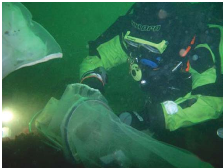
Fot. 3. Płetwonurek podczas poboru próby ilościowej za pomocą przyrządu DAK (fot. M. Kuliński)
