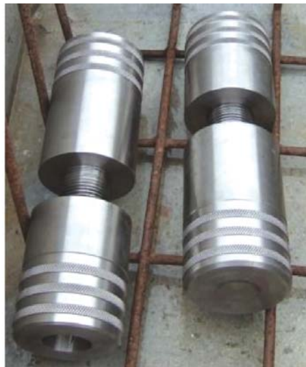
Fot. 2. Dodatkowe dociążenie czerpaka van Veen
