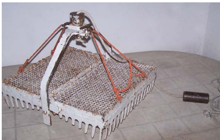
Fot. 1. Chwytnacz Bernatowicza – przyrząd do pośredniego poboru prób ilościowych makroglonów i okrytozależkowych (fot. Centrum Badań Ekologicznych PAN)
