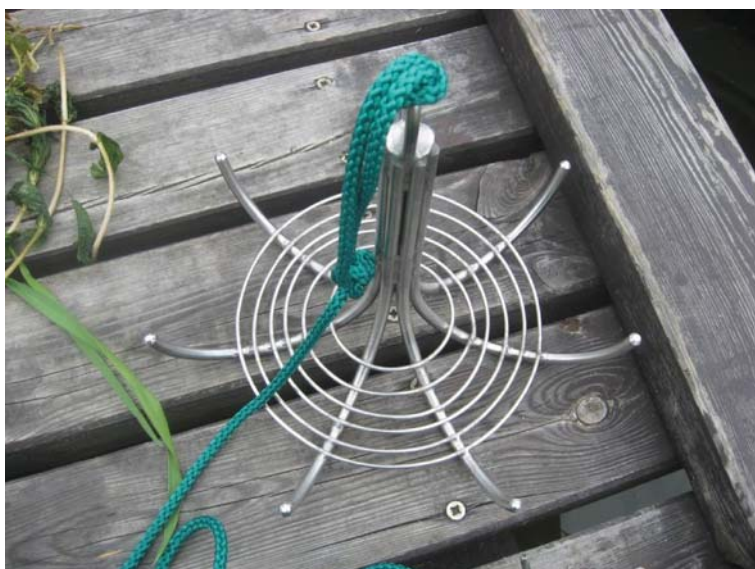
Fot. 2. Kotwiczka – przyrząd do pośredniego poboru prób jakościowych makroglonów i okrytozależkowych (fot. Uniwersytet Przyrodniczy w Poznaniu)
