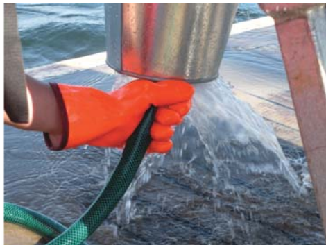
Fot. 7. Sposób postępowania z zatkany sitem
