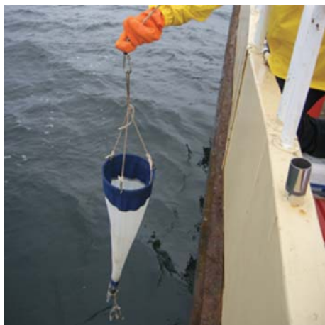
Fot. 3. Umocować siatkę do linki (fot. M. Kuliński)
