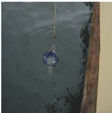
Fot. 4. Opuścić siatkę na zadaną głębokość (fot. M. Kuliński)
