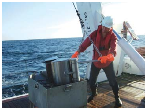
Fot. 4. Opuszczanie czepaka na płuczkę
