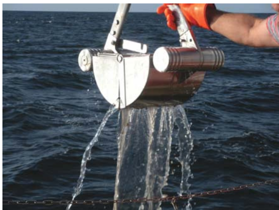
Fot. 3. Niedomknięty czepak (konieczność ponownego poboru próby)
