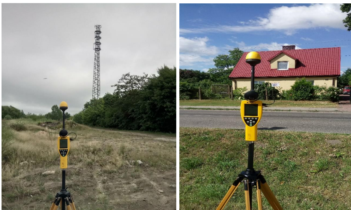
Zdjęcie 5.1. Pomiar PEM miernikiem Narda (źródło: PMS)
