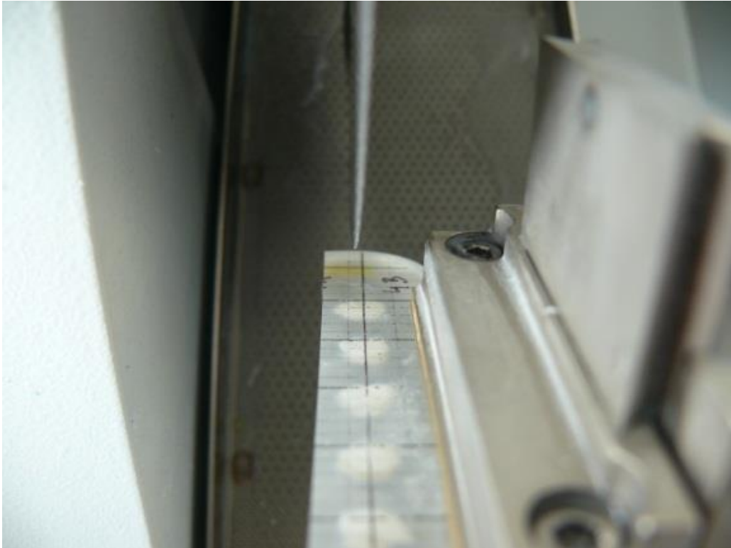
Fot. 67. Blok z otolitami prawidłowo umieszczony w imadle przecinarki (fot. Zuzanna Mirny)
