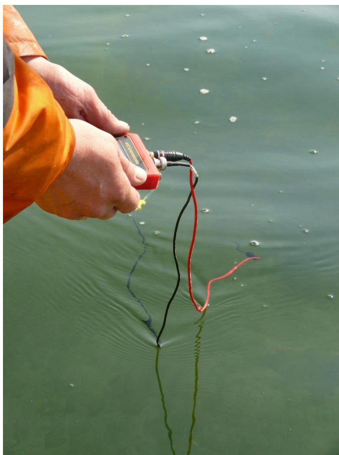
Fot. 20. Pomiar przewodnictwa elektrycznego w wodzie prostym miernikiem terenowym (fot. Iwona Psuty)
