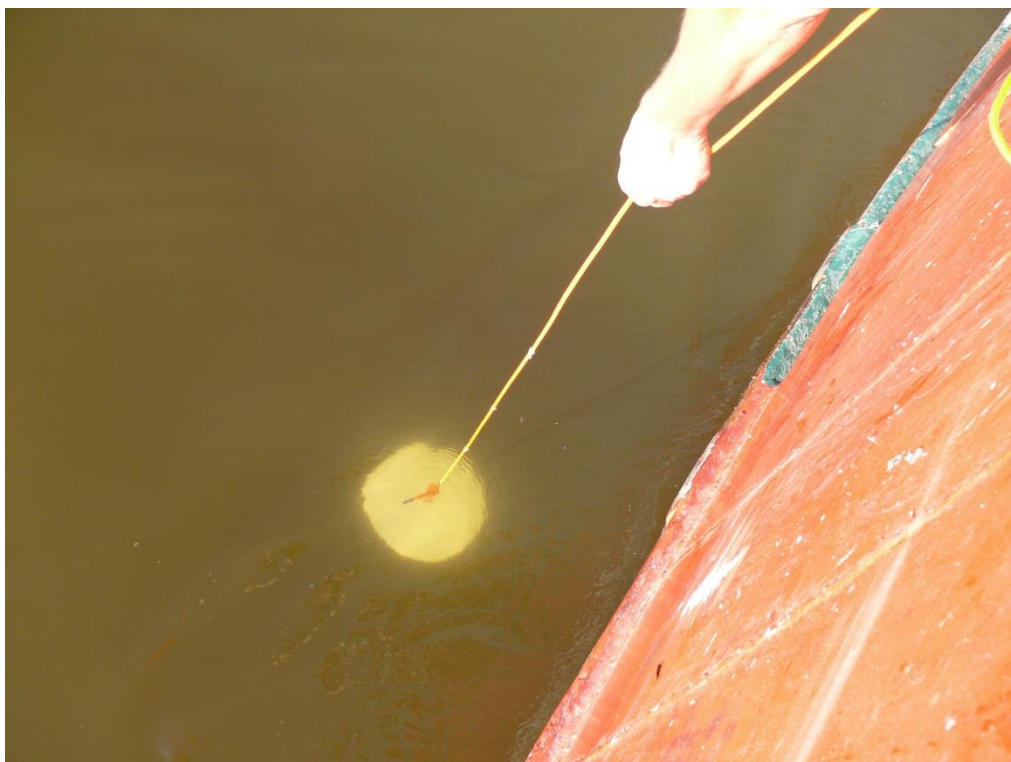
Fot. 21. Pomiar przezroczystości wody z pokładu jednostki rybackiej (fot. Iwona Psuty)
