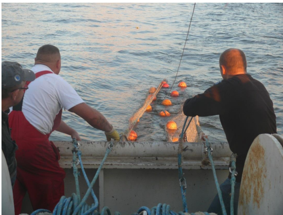
Fot. 16 Wydawanie włoka dennego na kutrze rybackim (Ujście Wisły). Na dole widoczny bęben z linami. (fot. Iwona Psuty)
