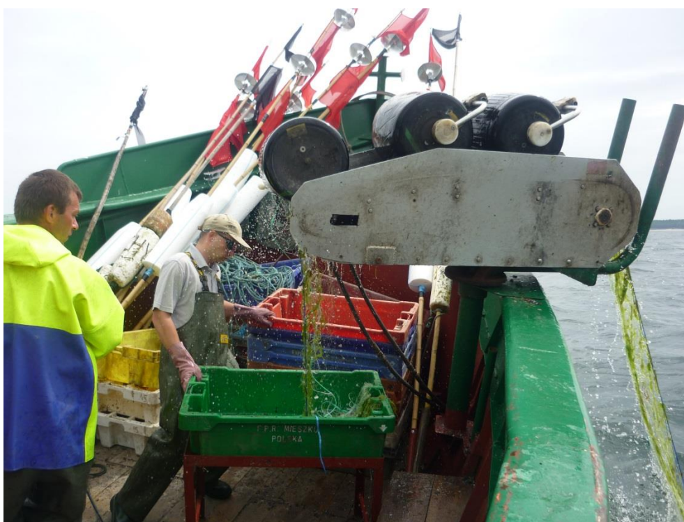
Fot. 14. Wyciąganie sieci z połowem przy użyciu wyciągarki hydraulicznej (wybrzeże środkowe) (fot. Iwona Psuty)
