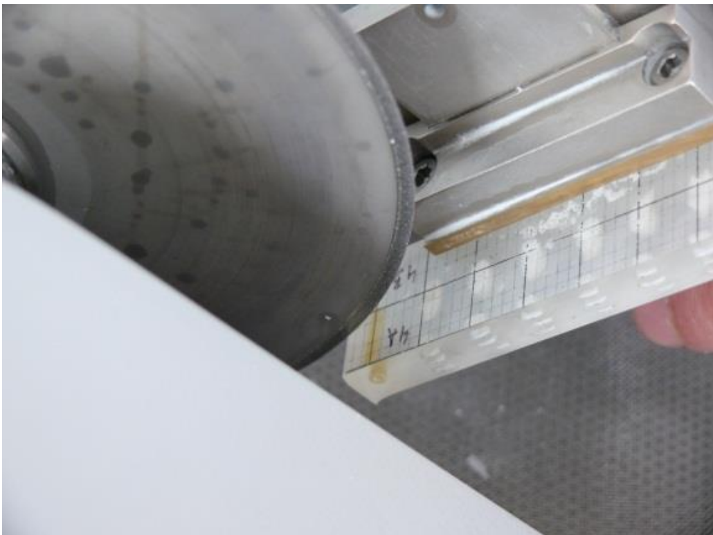
Fot. 68. Blok z otolitami prawidłowo umieszczony w imadle przecinarki (fot. Zuzanna Mirny)
