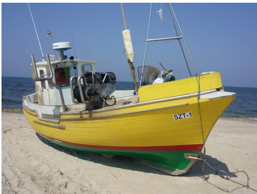
Fot. 10. Rybacka łódź pokładowa dostosowana do połowów sieciami stawnymi - przystań plażowa na Mierzei Wiślanej (fot. Iwona Psuty)
