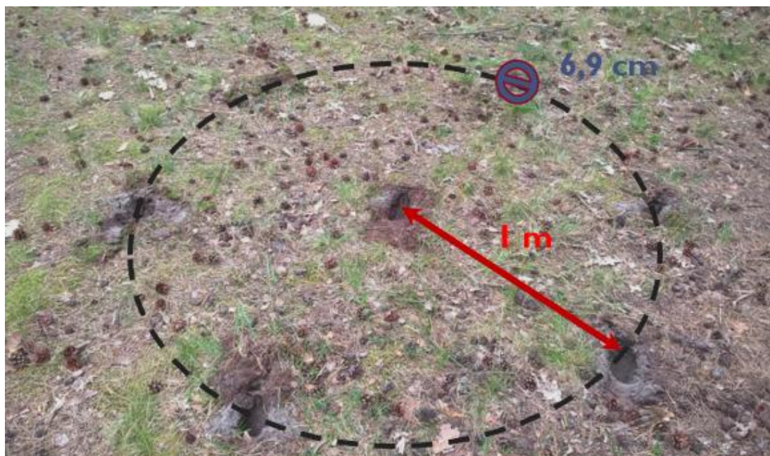
Rys. 2. Metoda poboru pojedynczej próbki gleby.
