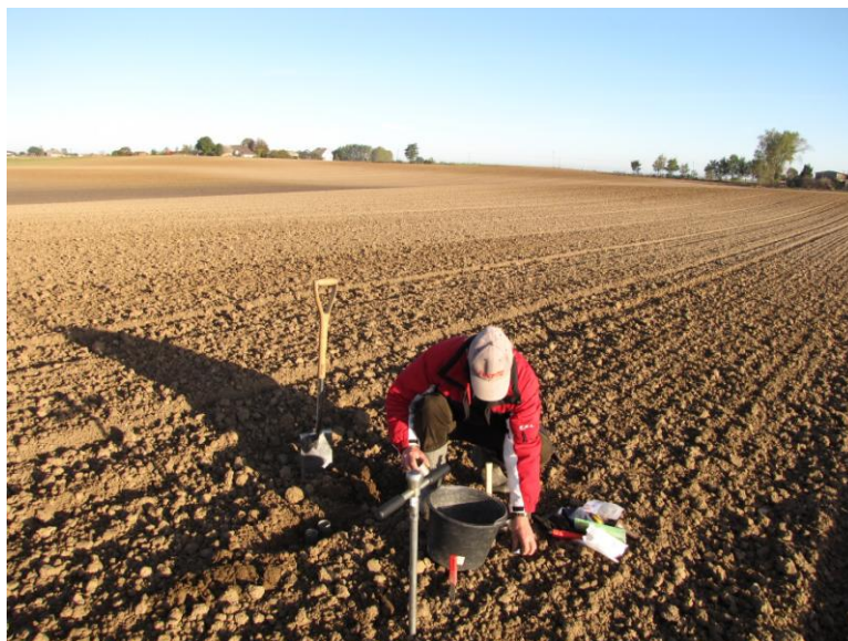
Fotografia 1. Pobieranie próbki glebowej w punkcie kontrolno-pomiarowym
