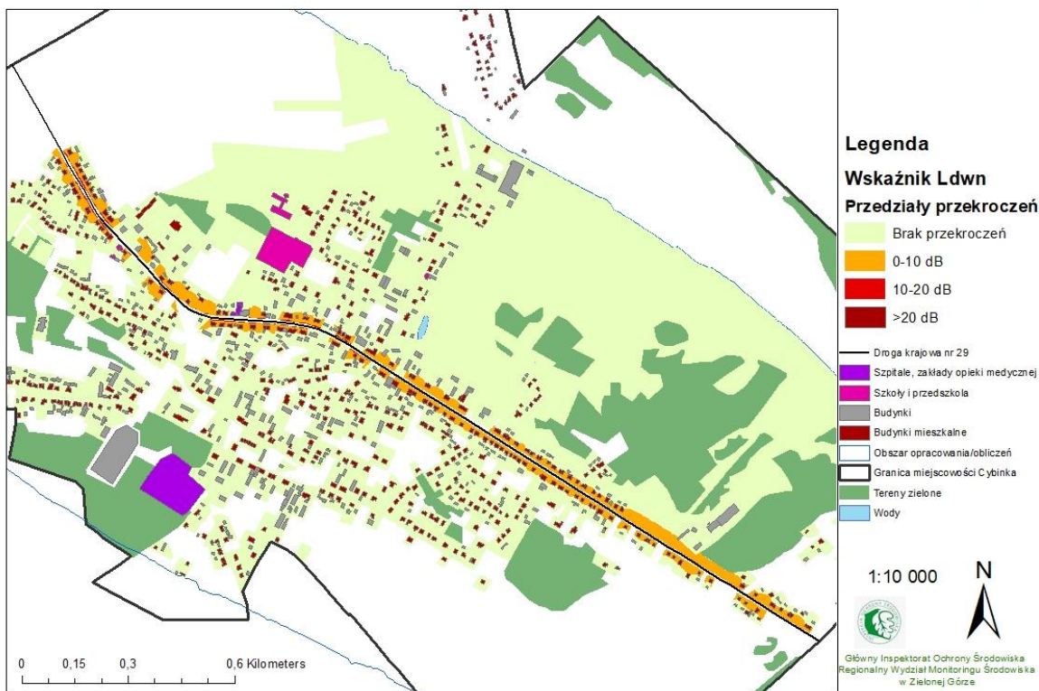
Rysunek 16. Graficzne przedstawienie wyników lokalnej mapy hałasu dla miejscowości Cybinka – Przekroczenie poziomu dopuszczalnego wyrażone wskaźnikiem L dwn (źródło: GIOŚ)
