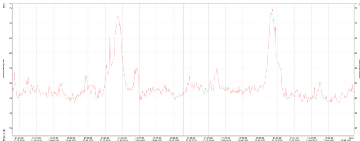
Ryc. 4. Przebieg zmian poziomu dźwięku A w funkcji czasu t dla przejazdu pociągów osobowych (14:26) (14:30), zarejestrowane w punkcie obserwacji dźwięku PR1, Cieszyn, rejon ul. Michejdy.
