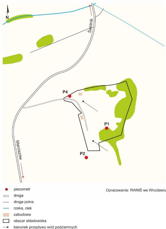
Rysunek 11. Lokalizacja punktów poboru próbek wód podziemnych na terenie i wokół składowiska w Ciechanowicach
