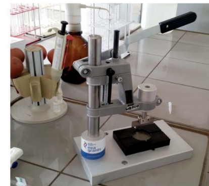
Urządzenie do cięcia filtrów z poborników pyłowych, laboratorium WIOŚ Kraków (fot. Andrzej Pindel)
