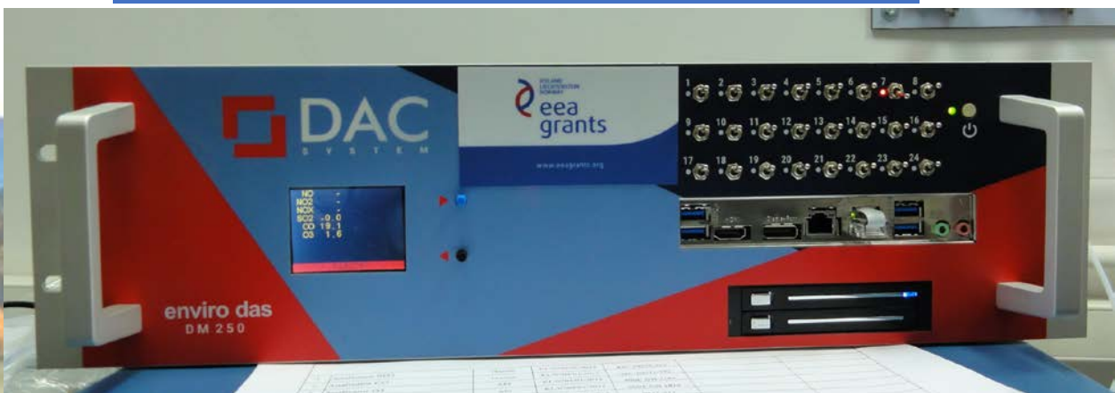
System zbierania danych - data logger
