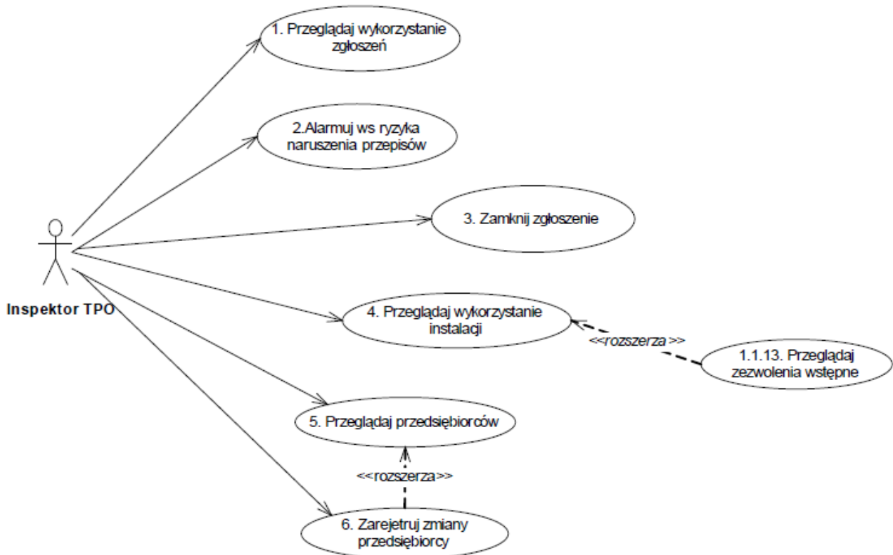
Rysunek 4. Diagram przypadków użycia dla podpakietu 1.3. Monitoruj realizację przemieszczeń
