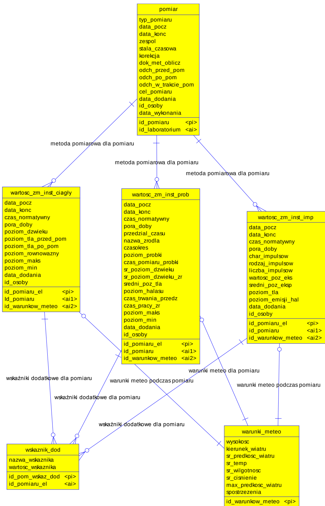
Rys. 3.8. Diagram związków encji dla pomiaru (instalacje)
