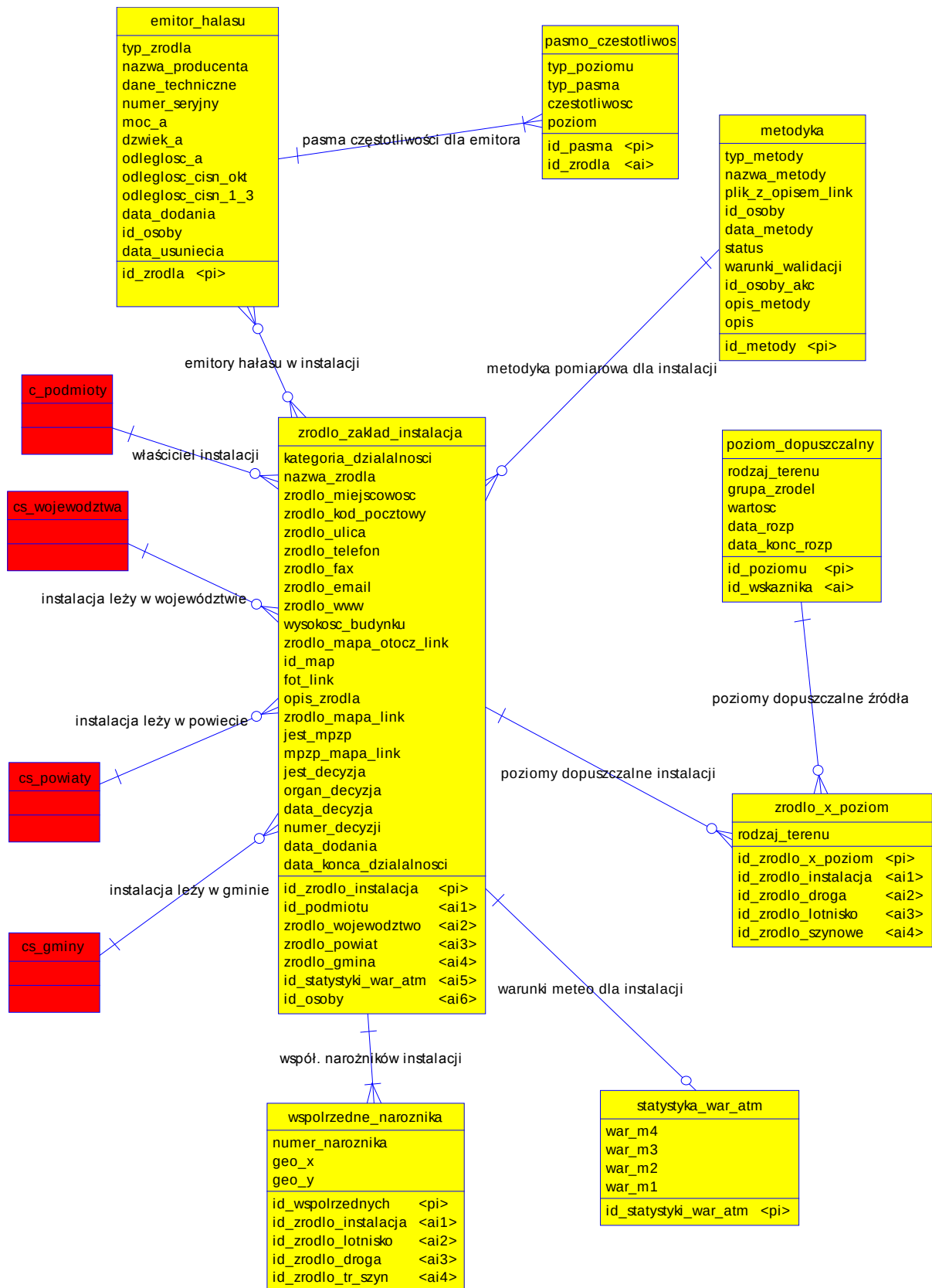
Rys. 3.1. Diagram związków encji dla bazy informacji o źródłach hałasu (źródło – instalacja)
