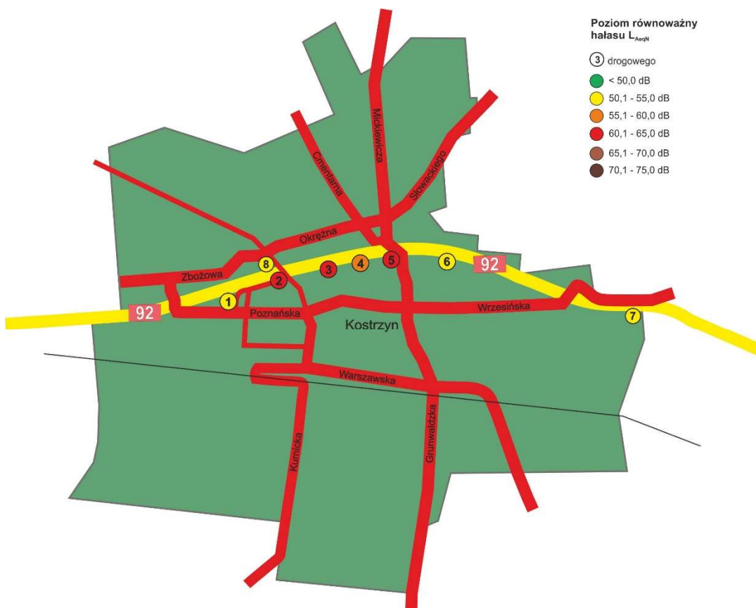
Mapa 8. Lokalizacja punktów pomiarowych hałasu drogowego w m. Kostrzyn, przy drodze krajowej nr 92, w 2018 roku - pora nocna (źródło GDDiKA)
