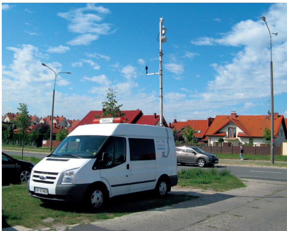
Fot. 4.1. Mobilna stacja monitoringu hałasu (źródło: WIOŚ)
