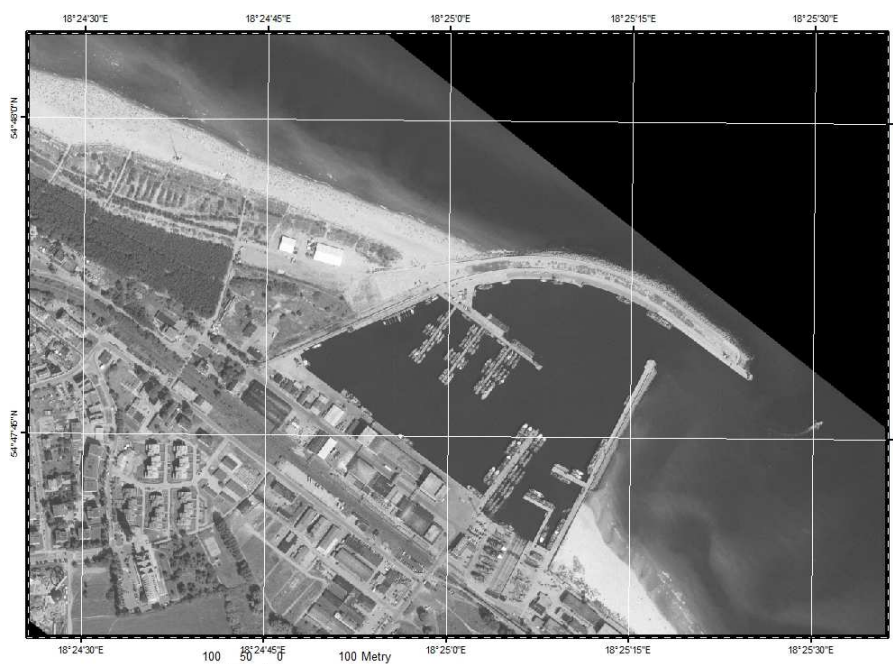
Rys. 1.2.2. Strefy akumulacji osadów w rejonie falochronów portu we Władysławowie (na podstawie ortofotomapy CODGiK, CODGiK, 2009)
