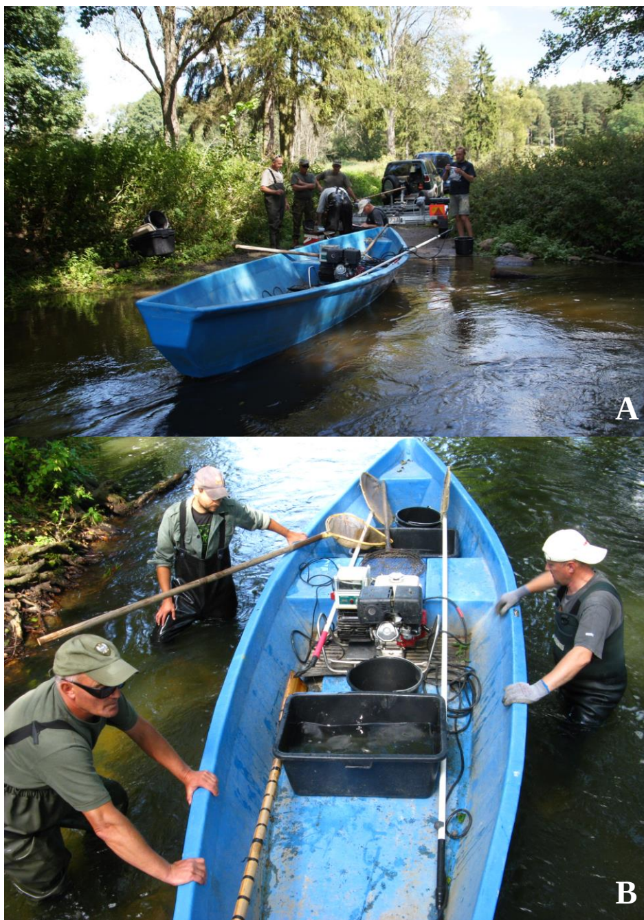
Ryc. 7. Zestaw do transportu łodzi (A) oraz sprzęt przygotowany do połowu z łodzi z zastosowaniem agregatu stacjonarnego wyposażonego w dwie anody (B) (fot. M. Adamczyk, J. Szlakowski).
