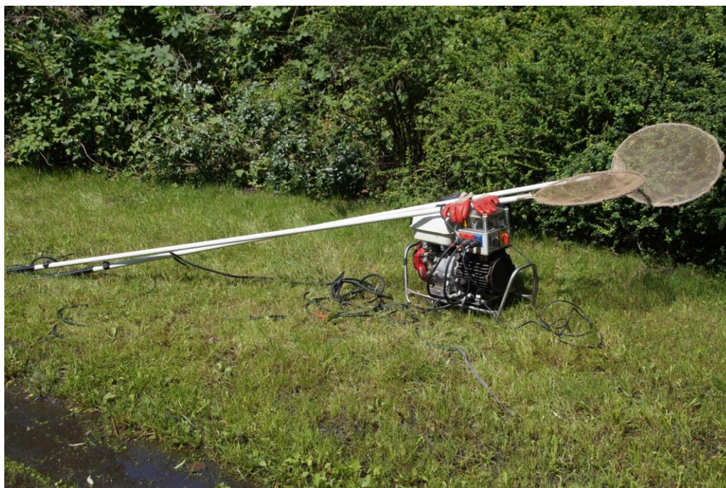
Ryc. 5. Stacjonarny agregat prądotwórczy do połowów z łodzi (fot. M. Adamczyk).
