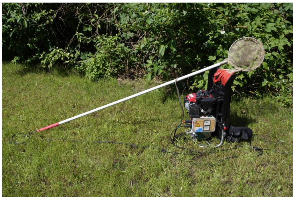
Ryc. 4. Plecakowy agregat prądotwórczy do połowów metodą brodzenia (fot. M. Adamczyk).
