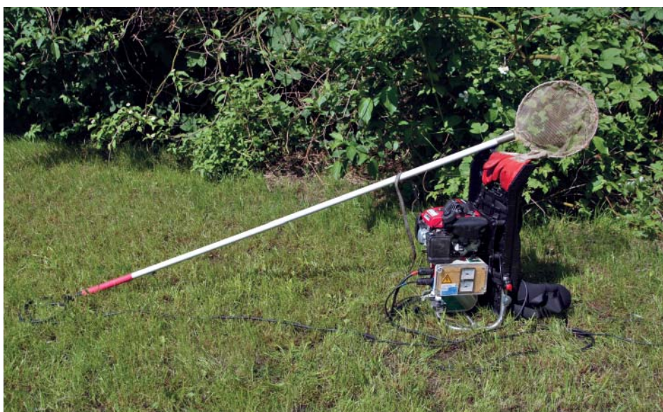
Ryc. 4. Plecakowy agregat prądotwórczy do połowów metodą brodenia (fot. M. Adamczyk)
