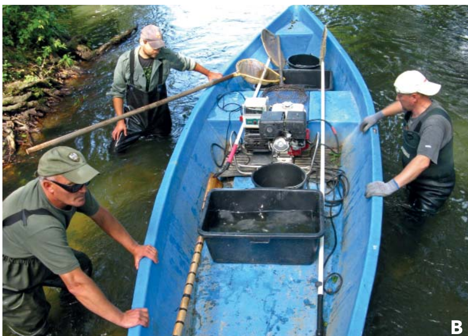
Ryc. 7. Zestaw do transportu łodzi (A) oraz sprzęt przygotowany do połowu z łodzi z zastosowaniem agregatu stacjonarnego wyposażonego w dwie anody (B) (fot. M. Adamczyk, J. Szlakowski)
