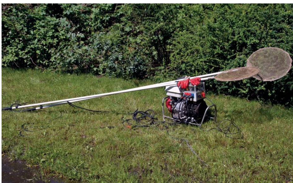
Ryc. 5. Stacjonarny agregat prądotwórczy do połowów z łodzi (fot. M. Adamczyk)
