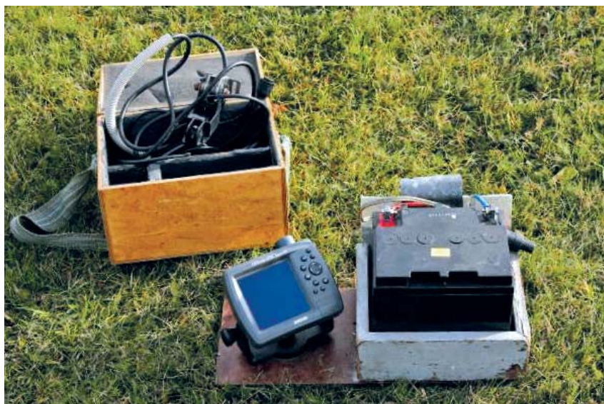
Fot. 17a. Echosonda z GPS wykorzystywana w czasie badań (fot. Łucjan Chybowski)
