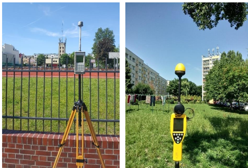
Fotografia 2.1. Pomiar PEM miernikami Narda i PMM (źródło: GIOŚ)
