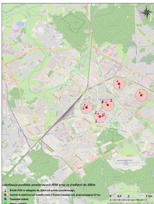
Mapa 5. Lokalizacja punktów monitoringu pól elektromagnetycznych w Białymstoku wraz z występującymi źródłami w odległości do 300m od punktu pomiarowego.
