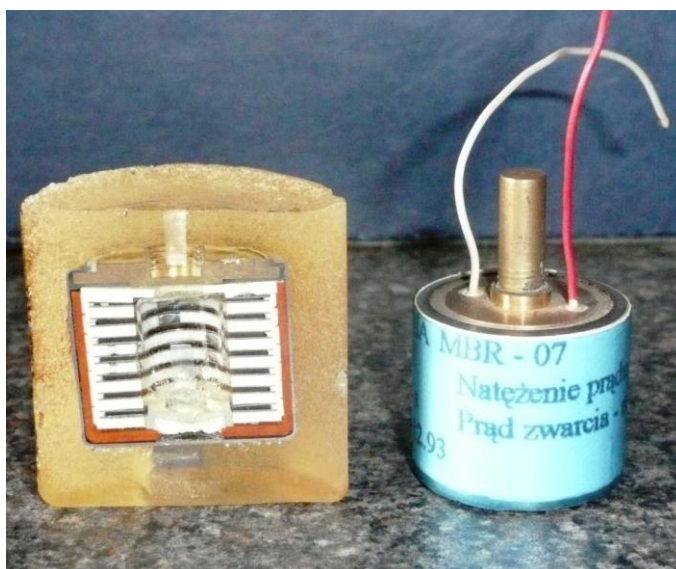
Przekrój baterii MBR – 07, bateria MBR – 07
